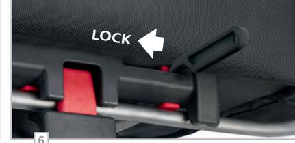
**Automatische Anpassung an Gepäckträgerdurchmesser** Die vorgespannten Tasten stellen sich automatisch ein und fixieren das Zubehör sicher und spielfrei auf Gepäckträgerstreben mit  $\varnothing$  8-16mm.
