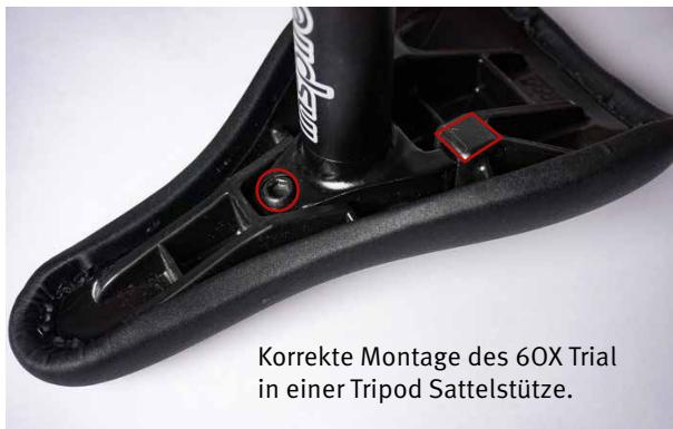
Korrekte Montage des 60X Trial
